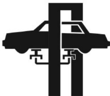
Positionner le centre de gravité du véhicule entre les bras de levage
