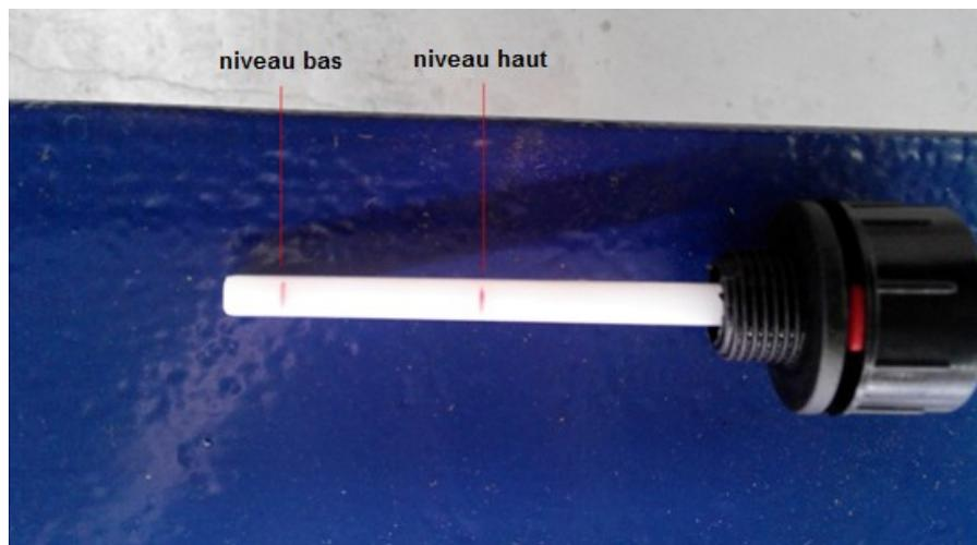
Figure 6 - Contrôle du niveau d'huile
