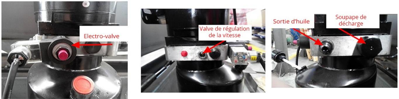
Figure 9 - Présentation des valves hydrauliques
