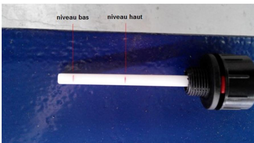
Figure 1 - Contrôle du niveau d'huile
